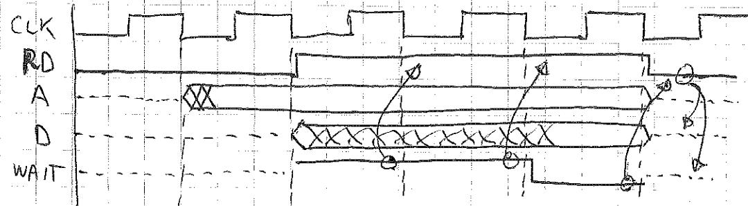
Para activar la línea WAIT se coloca un circuito generador de ciclos de espera
