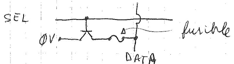
Los  $\Phi$  se pueden cambiar por 1s aplicando una intensidad fuerte de corriente para quemar el fusible. Pero una vez que se quema el fusible, no se puede regresar a  $\Phi$ .
