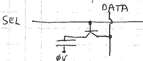
Para escribir el bit se coloca SEL en 1 y un 0 o 1 en DATA, lo que descarga o carga el condensador. Cuando SEL = 0 el condensador se mantiene aislado, por lo que mantiene su carga por algunos milisegundos. Para leer el dato se coloca SEL en 1. Si el condensador está cargado, se descarga generando una débil corriente que es detectada como 1. Esto significa que la lectura es destrutiva; después de leer un bit hay que reescribirlo para no perder los bits.
