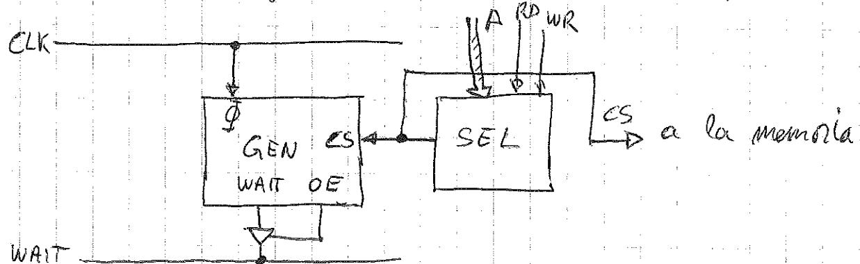
GEN es un circuito secuencial que examina la última línea CS que a la memoria. Cuando detecta un 1 en un ciclo, coloca WAIT en 1 por 2 ciclos y luego  $\phi$  en el tercer ciclo. Cuando CS es  $\phi$  WAIT queda en tri-state. El diagrama de estados para GEN es:
