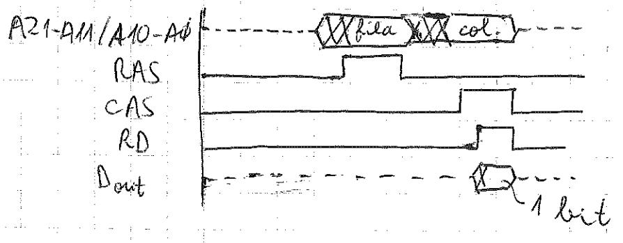
Durante el acceso a la fila se lee toda la fila de condensadores. Como la lectura es destructiva (es decir descarga los condensadores), la fila se reescribe completamente a final del acceso. En el acceso a la columna se selecciona un bit dentro de la fila.
