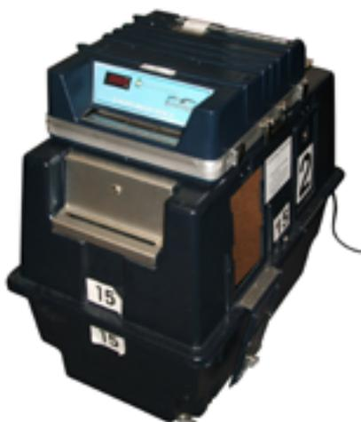
**Figura 2.** Escáner usado para leer papeletas de votación en la forma de formularios.
