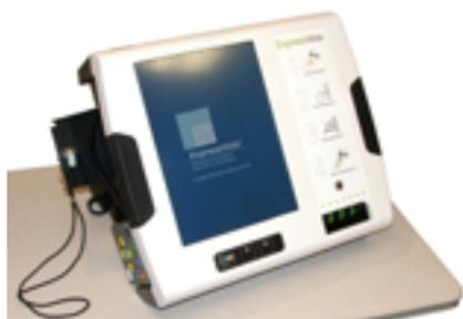
**Figura 3.** Computador marcador de papeletas: solicita las preferencias al usuario y luego las imprime en una papeleta de votación.
