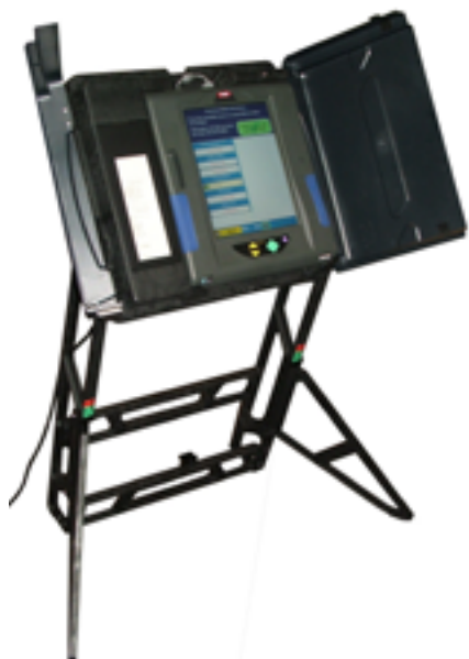
Figura 7. Máquina DRE con VVPAT. La ventana de plástico transparente (a la izquierda en la foto) muestra la papeleta impresa completa para su aprobación por el votante.
