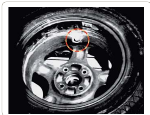
Accidente en una llanta producto de una inspección deficiente
